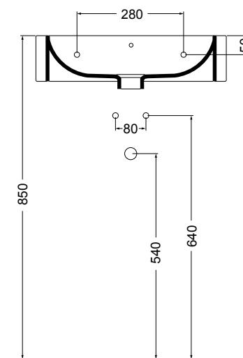
N.B.: Le misure indicate possono subire una variazione dello 0,8 % circa, dovuta ad usura stampi o a piccole variazioni delle caratteristiche tecniche relative alle materie prime che compongono l' impasto.
